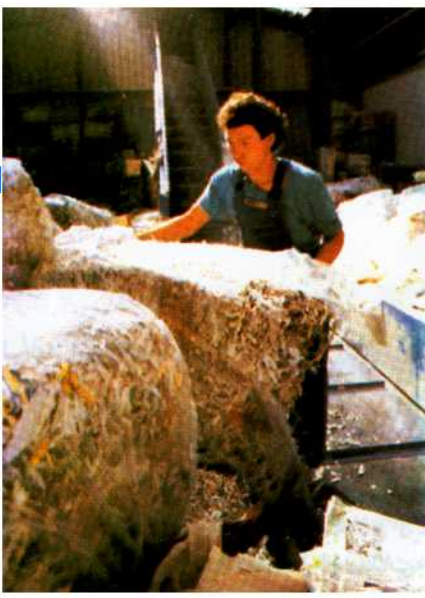
أحد مصانع الورق التي تستخدم الورق القديم الذي تم جمعه لتحويله إلى ورق جديد .
