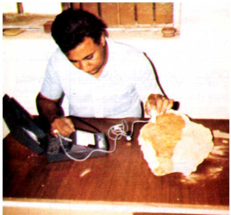
٤ - جهاز بروتوميتر سرفيماستر لقياس الرطوبة والحرارة داخل وعلى سطح الحجر .
