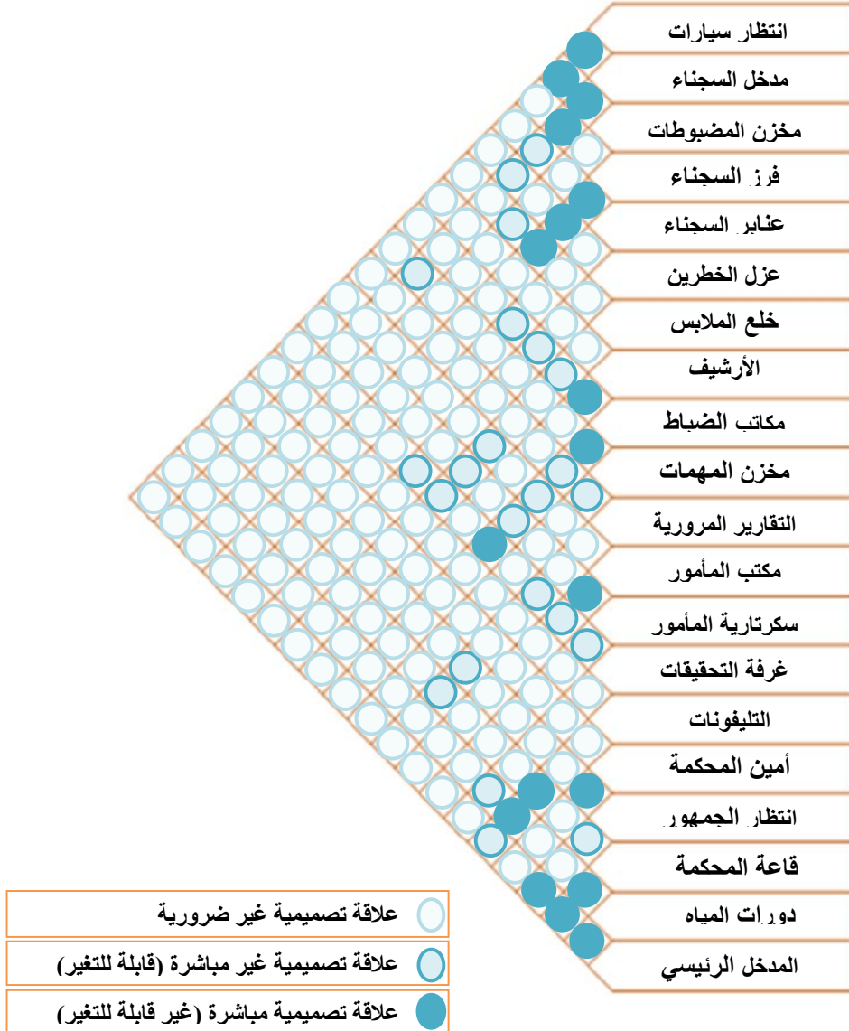
شكل ٤٢: رسم كروكي يوضح العلاقات بين الفراغات الوظيفية المختلفة المكونة لمبنى قسم الشرطة القياسي المصدر: توضيح الدراسة
