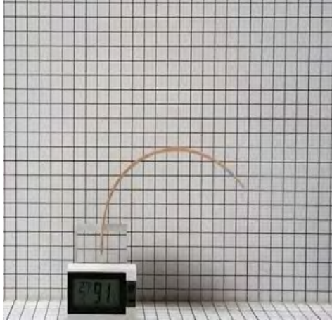
شكل (٨٩-٢) يوضح انحناء الخشب عند درجة حرارة (C27) والرطوبة (٩١٪)
