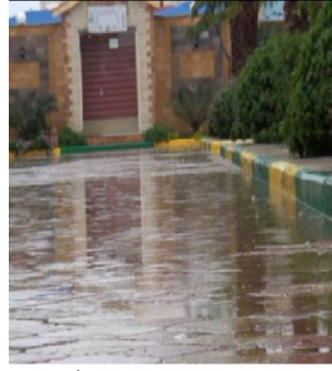
شكل (١٨): عدم وجود شبكات وميول لصرف مياه الأمطار لأعمال تنسيق الموقع (الدراسة الميدانية، الباحث)
