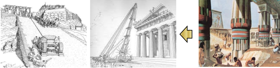
شكل (١٢): ابتكار الإغريق للبكرات والروافع شكل طفرة فكرية في أساليب البناء الحجرية المتبعة قبل ذلك، شبكة الانترنت.
