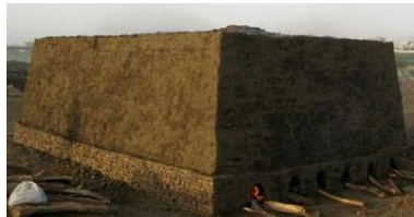
شكل (٧): الأسلوب التراثي لحرق الطوب، المصدر: (http://www.brickdirectory.co.uk)
