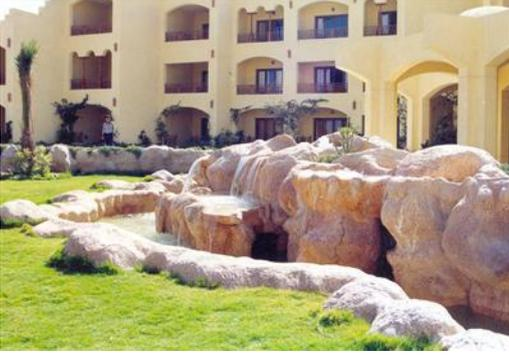
شكل(٢-٢٤) : استخدام الخرسانة المسلحة بالألياف الزجاجية في عمل الصخور الصناعية
