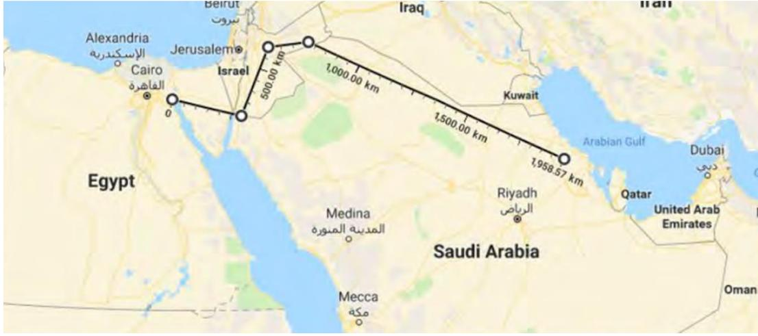
شكل (٤٦-٥) خط الربط المقترح لربط شبكة الكهرباء الخليجية بشبكة كهرباء مصر
