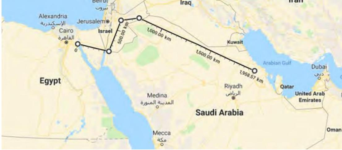
شكل (٩-١٠) خط الربط المقترح لمشروع الربط الكهربائي المصري السعودي
