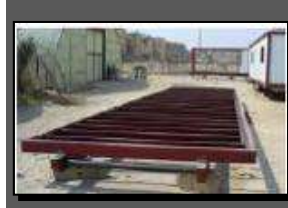
الزحافة الفولاذية التي يرفع عليها الكرفانات
