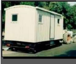
المنشأ التنقل (الكرفان) بعد وضعه علي المقطورة لتحميله إلي الموقع
