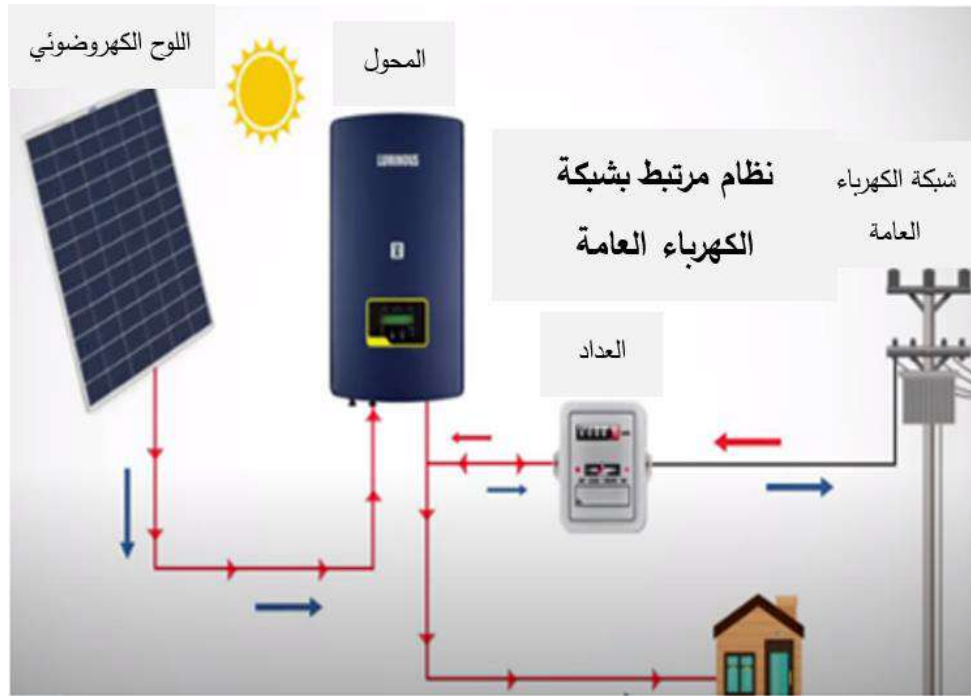
شكل (٣-٢١) نظام كهروضوئي متصل بالشبكة ON Grid Solar System بتصرف عن المصدر: https://www.youtube.com/watch?v=rCaPWLaknII&list=L&index=76
