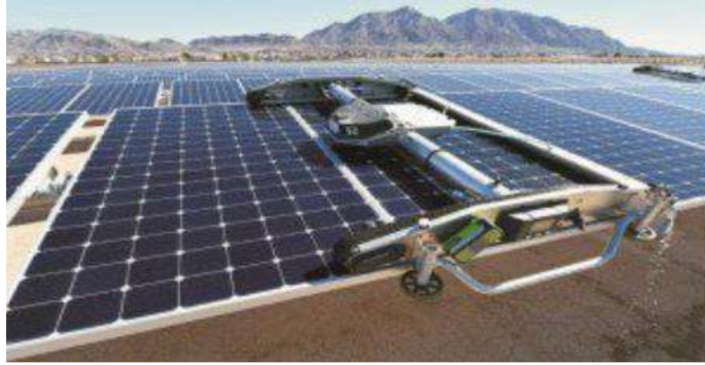
شكل (٣-٧٩) نظافة الخلية الكهروضوئية آلياً المصدر:
