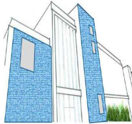
شكل (٥٢-٣) مبنى Hanergy Office، جوانجدونج، الصين، تركيب ألواح BIPV في الجدران التقليدية
