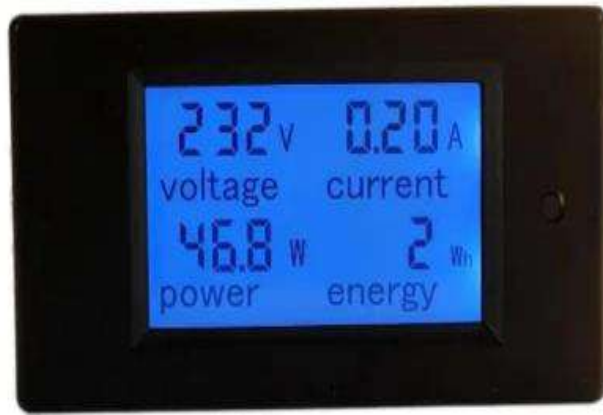
شكل (٨-٤) جهاز قياس فرق الجهد والتيار (Multi meter) المستخدم في التجربة المصدر: تصوير الباحث في ١٤-٨-٢٠٢٣
