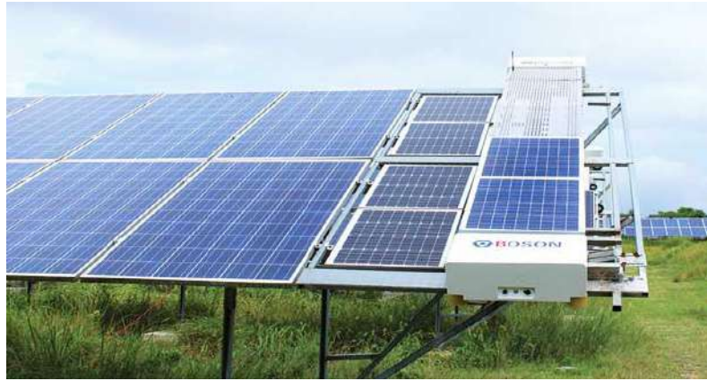
شكل (٣-٨٠) نظافة الخلية الكهروضوئية آلياً بواسطة جهاز التنظيف الذي يعمل بالطاقة الكهروضوئية المصدر:
