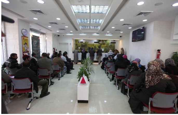
شكل (5.39): استخدام بلاط البورسلان 60*60سم والنواح الجبس وبلاطات السقف 60*60سم.
