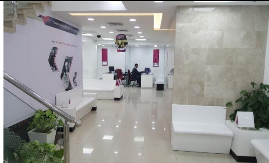
شكل (5.10): استخدام الرخام العماني في كسوة الحوائط (فرع الرمال).
