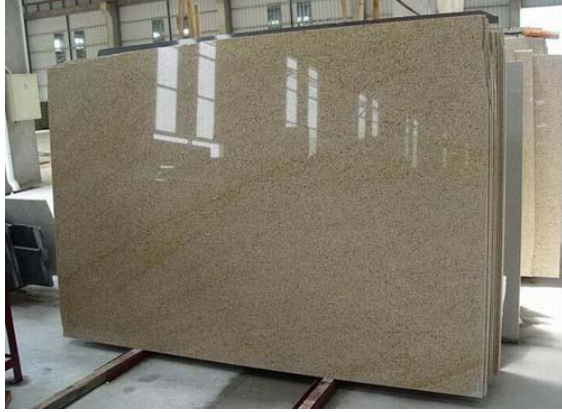
شكل (2.27): الرخام بعد عملية الصقل وقبل التقطيع للتركيب.
