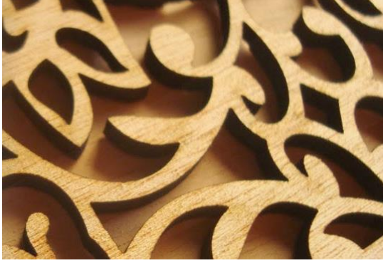
شكل (2.12): تشكيل من انواع مختلفة من الرخام نفذ بواسطة آلات Water jet (قص وتفريغ) شكل (2.13): تشكيل الخشب بواسطة آلات water jet (قص وتفريغ)
