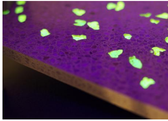
شكل (2.9): الاسمنت المضيء أو المشع (Luminous concrete)
