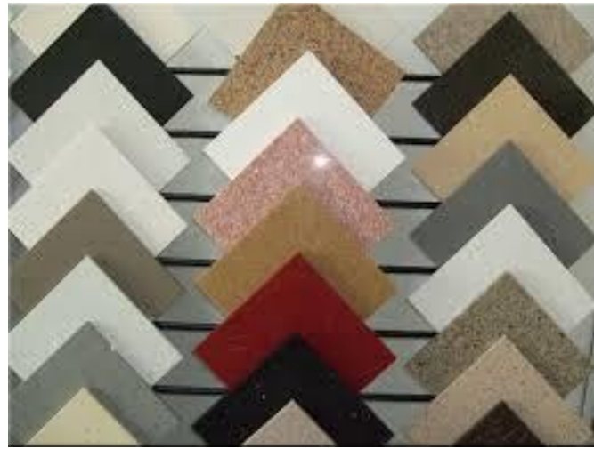
شكل (2.19): أشكال وألوان الرخام الصناعي المتعددة يستخدم في كسوة الحوائط والأرضيات.
