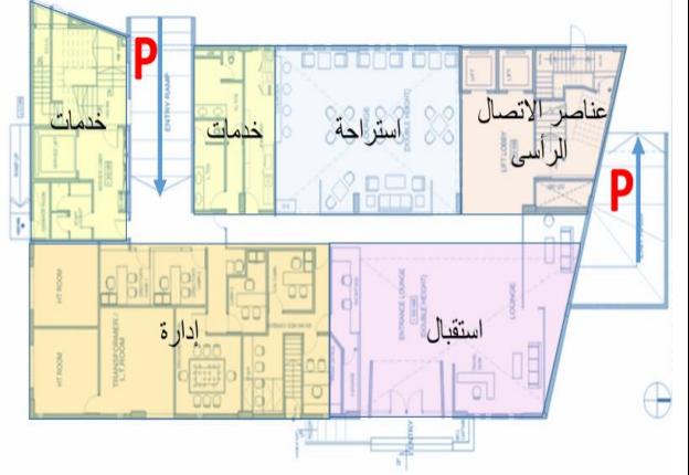
شكل (5-16) كروكى يوضح علاقة الاستقبال وبهو المدخل بباقى العناصر المصدر : م/ ألاء محمد عبد الغنى ( مرجع سابق )
