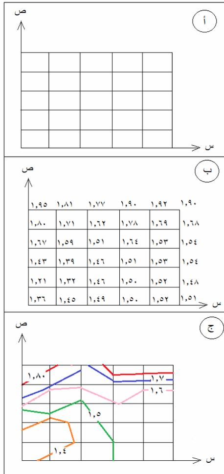
شكل (١٠-٥) طريقة المربعات لإنشاء خطوط الكنتور
