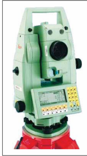
شكل (٩-٤) مثال لجهاز المساحة الأرضية من نوع المحطة الشاملة
