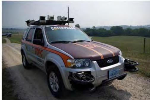
والسيارة مجهزة بعدة مستشعرات sensors تشمل مستشعر الملاحة بالقصور الذاتي Inertial Navigation System (INS) وجهاز GPS وعدة مستشعرات LiDAR بالإضافة لمجموعة من مستشعرات الليزر لاكتشاف العقبات و تفاديها.
