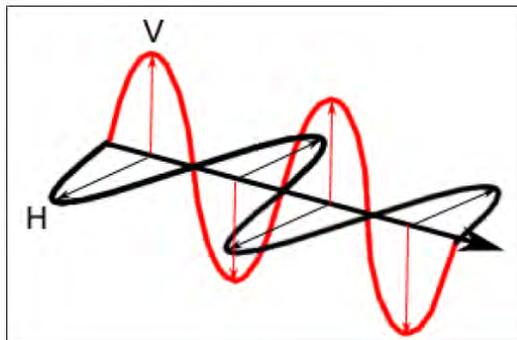
شكل (٤-٧) قطبية المجال الكهربائي
