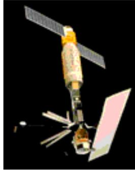
أطلقت وكالة الفضاء الأوروبية نظام ERS-1 في عام ١٩٩١ حاملا جهاز قياس الارتفاعات الرادارية radar altimeter وجهاز قياس الاشعة تحت الحمراء و الموجات القصيرة infrared and microwave sounder وأيضا جهاز رادار يعمل في النطاق C (٥.٦٦ سنتيمتر). ومن ثم فيستطيع هذا النظام قياس الانعكاسات من سطح المحيطات وأيضا قياس سرعة و حركة الرياح السطحية. ويمكن للنظام أن يعمل كمنفذ صناعي SAR لتجميع البيانات في مسار عرضه ١٠٠ كيلومتر بزوايا سقوط بين ٢٠ و ٢٦ درجة وبدرجة وضوح مكانية تبلغ ٣٠ متر تقريبا.
