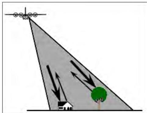
شكل (٤-٣) مبدأ الرadar في الاستشعار الموجب بالمايكروويف
