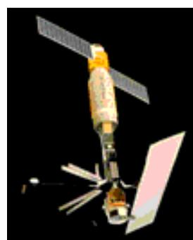
أطلقت وكالة الفضاء الاوروبية نظام ERS-1 في عام 1991 حاملاً جهاز قياس الارتفاعات الرادارية radar altimeter وجهاز قياس الاشعة تحت الحمراء و الموجات القصيرة infrared and microwave sounder وأيضاً جهاز رادار يعمل في النطاق C (٦٦.٥ سنتيمتر). ومن ثم فيستطيع هذا النظام قياس الانعكاسات من سطح المحيطات وأيضاً قياس سرعة و حرارة الرياح السطحية. ويمكن للنظام أن يعمل كمنفذ صناعي SAR لتجمیع البيانات في مسار عرضه ١٠٠ كيلومتر بزاوية سقوط بين ٢٠ و ٢٦ درجة وبدرجة وضوح مكانية تبلغ ٣٠ متر تقريباً.
