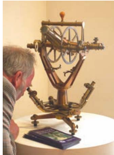
شكل (١-٣) نماذج لأجهزة ثيودوليت قديمة لقياس الزوايا
