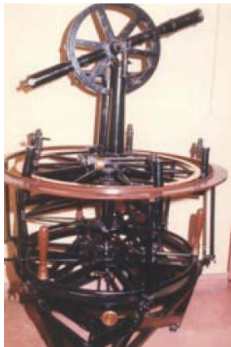
شكل (١-٣) نماذج لأجهزة ثيودوليت قديمة لقياس الزوايا
