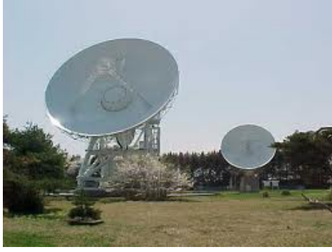
شكل (٧-١) هوائيات تحديد المواقع بتقنية VLBI
