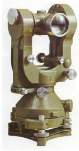
شكل (٤-١) جهاز الثيودوليت الشهير Wild T2 للقياسات الأرضية
