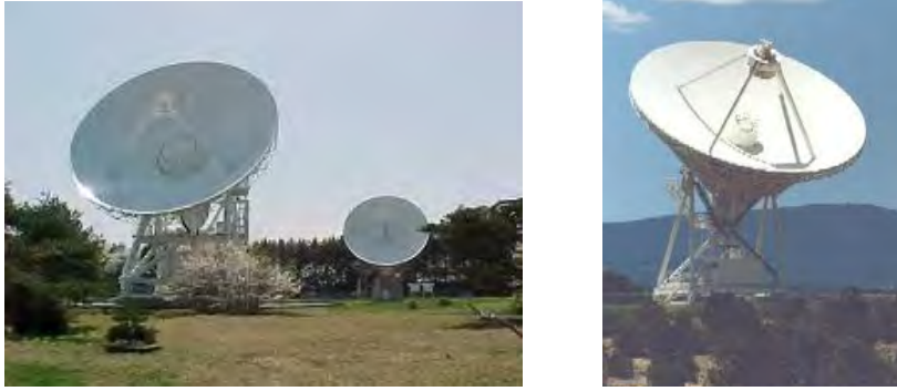
شكل (٧-٢) هوائيات تحديد المواقع بتقنية VLBI
