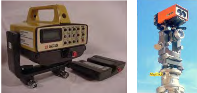
شكل (٤-١١) أجهزة قياس المسافات الكترونيًا
