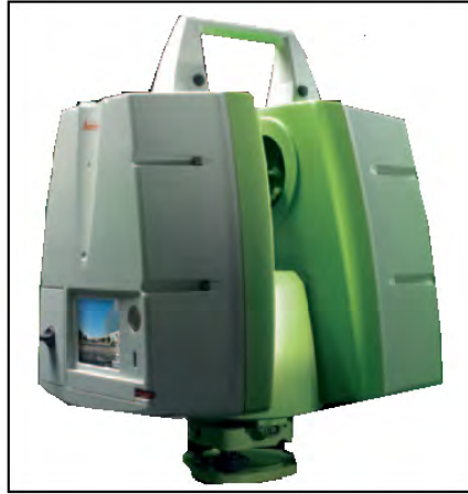
شكل (٩-٤) مثال لجهاز المحطة الشاملة بالمسح الليزري
