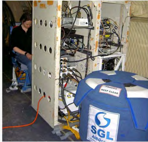
شكل (١٥-١٤) جهاز قياس الجاذبية الأرضية من الجو
