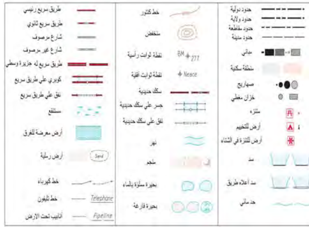
شكل (٢٩-٤٤) نموذج لمفتاح الخريطة الطبوغرافية مقياس رسم ١ : ٢٥,٠٠٠ في أمريكا
