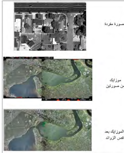
شكل (٢٣-٩) أنواع الصورة الجوية طبقا لشكلها
