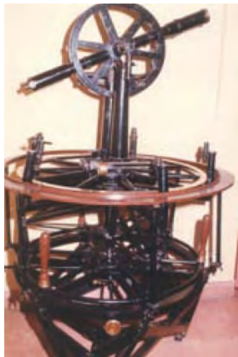
شكل (٣-٢) نماذج لأجهزة ثيودوليت قديمة لقياس الزوايا
