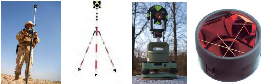
شكل (٤-١٢) عواكس أجهزة قياس المسافات الكترونيًا
