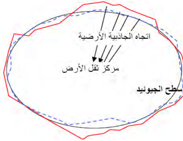
شكل (١٢-٢) الجيويد: الشكل الحقيقي للأرض
