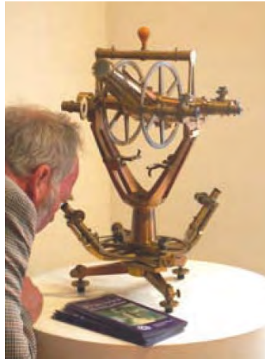
شكل (٣-٢) نماذج لأجهزة ثيودوليت قديمة لقياس الزوايا
