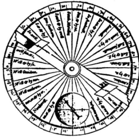
شكل (٢-٢) جهاز الاسطرلاب لقياس الزوايا
