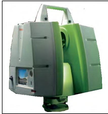
شكل (٩-٤) مثال لجهاز المحطة الشاملة بالمسح الليزري
