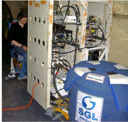
شكل (١٥-١٤) جهاز قياس الجاذبية الأرضية من الجو
