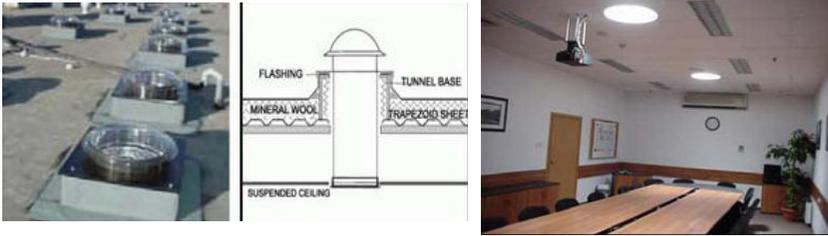
شكل(٣-٢٨) توظيف التقنيات الحديثة للاستفادة من الاضاءة الطبيعية باستخدام وحدات الاضاءة Skylight Sun Tube
