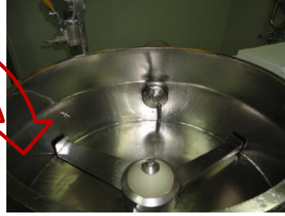
شكل (٢-٤) . جهاز الخلط الرطب المفتوح. المصدر: ( احدى الحالات الدراسية التي سيرد تحليلها )
