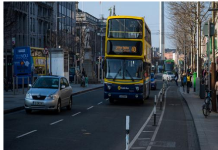
شكل 10: يوضح مسار الدراجات في مدينة دبلن بأيرلندا وهو مسار مجاور لرصيف المشاة تفصله المنطقة العازلة (دهان وأعمدة معدنية) عن حركة المرور. [23]
