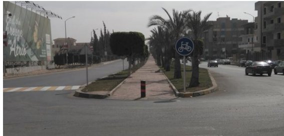
شكل 15: صورة توضح مسار الدراجات والمشاة والمنفذ باستخدام الخرسانة المطبوعة وتوسطه للجزيرة الوسطى للطريق. (من تصوير الباحث)
