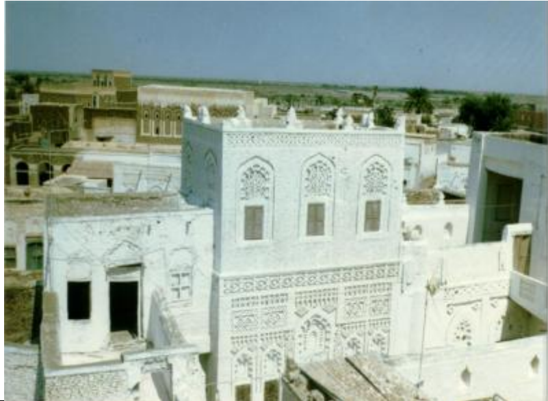
الشكل رقم ( ٢-٢ ) كيفية الاستفادة من بروز الأدوار العليا واختلاف مناسيب الأسطح لتضليل مساحة الأسطح للمباني.
