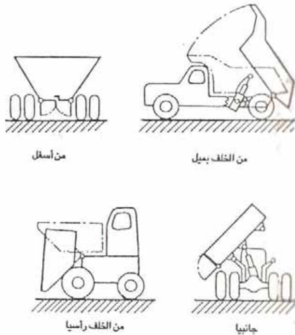
شكل (٣٢) الأشكال المختلفة لتفريغ صندوق اللورى
