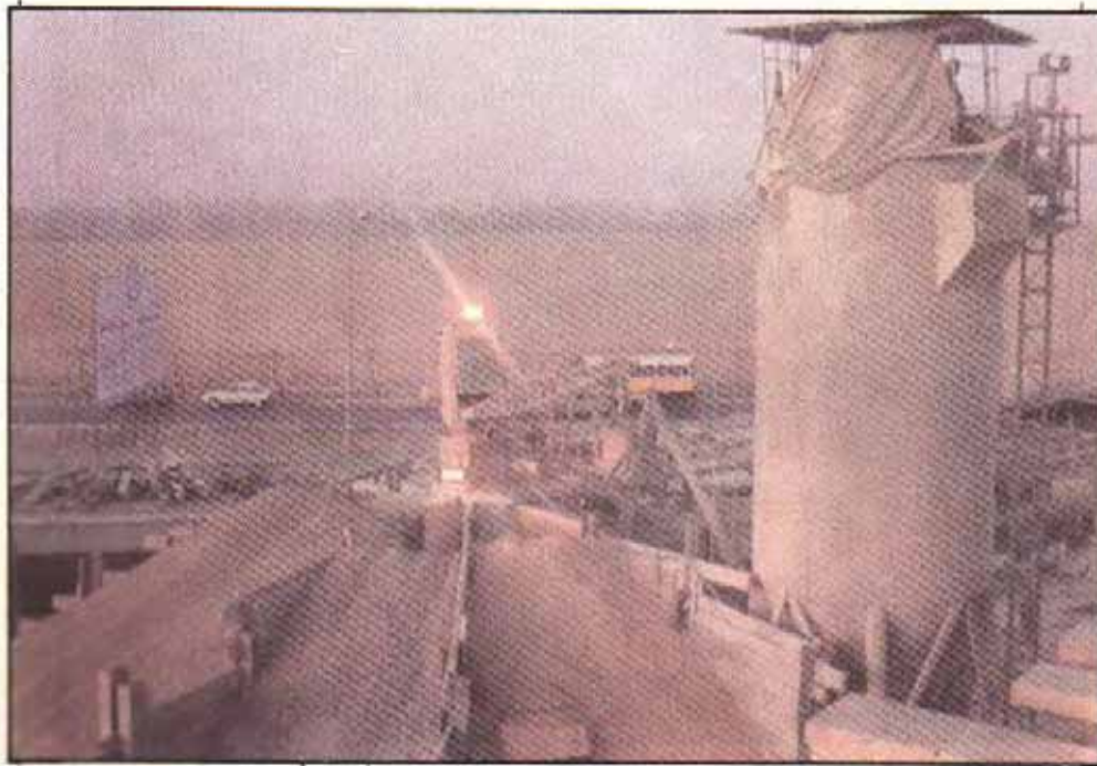
شكل (١٥٦) محطة خلط الخرسانة مع تشوينات الرمل والركام
