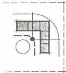
حركة الونش بشكل حرف L لتتناسب المبنى
