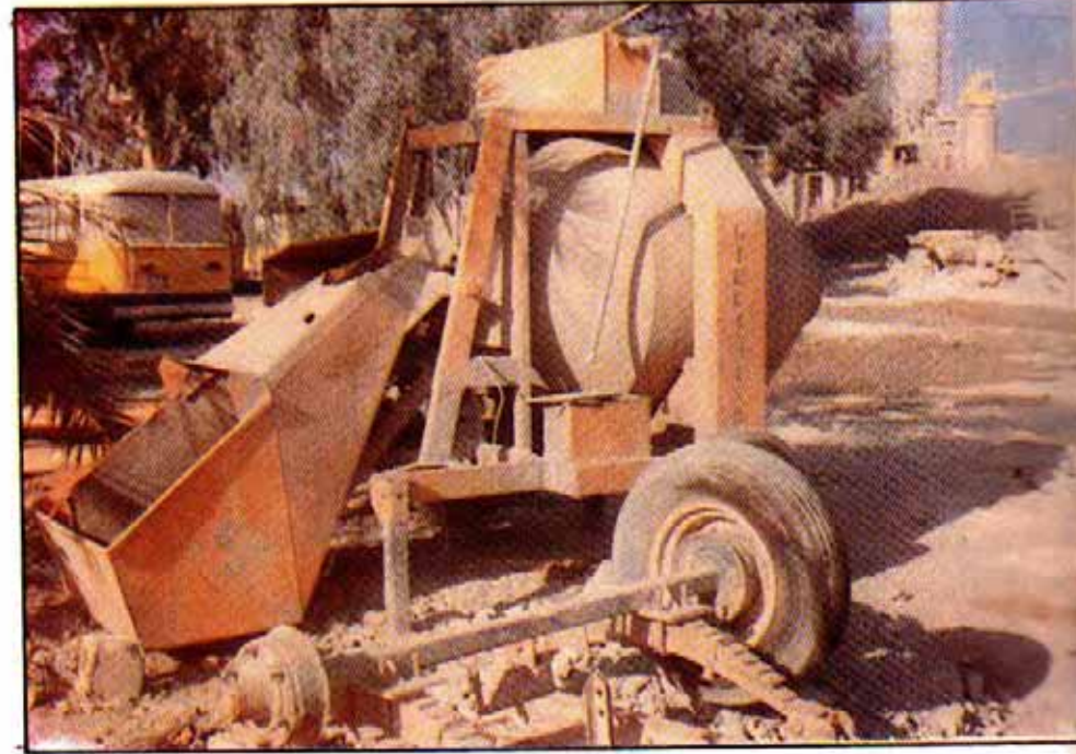
شكل (١٩٢) الخلاط النحلة ويلاحظ ماسورة الماء المغذية حلقة الخلاط.
