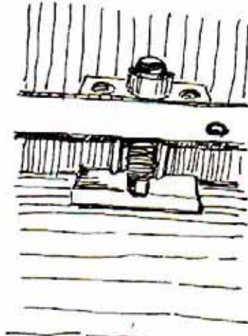
شكل (١٢٨) الروافع التي ترتكز عليها الشدة
