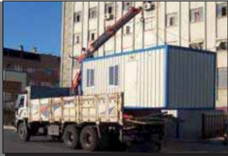
الرافعة تحمل المنشأ (الكرفان) ذات الحجم المتوسط إلي المقطورة
