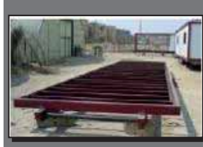
الزحافة الفولاذية التي يرفع عليها الكرفانات
