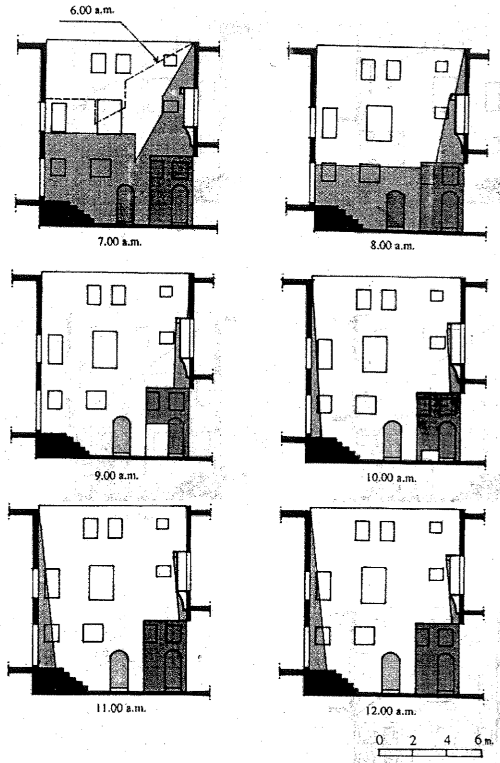
شكل (٦٤) المساحات المعرضة للشمس والمظللة بالواجهة الشرقية لفناء منزل جمال الدين ٢١ يونيو.
