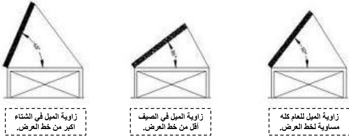
شكل ٥-٥. زوايا ميل الخلايا الكهروضوئية صيفا وشتاء. المصدر: www.agr.gc.ca ترجمة الباحثة.
