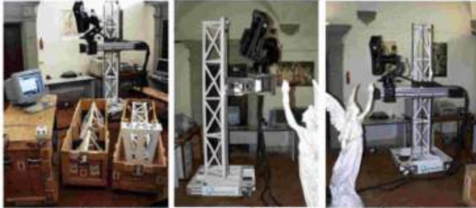
صورة رقم (15/2) أجهزة المسح البصري Optical باستخدام كاميرات متصلة بالحاسب الآلي، (المصدر : http://graphics.stanford.edu/projects/mich/mgantry-in-lab/mgantry-and-angel-s.jpg (Accessed 6/7/2006))
