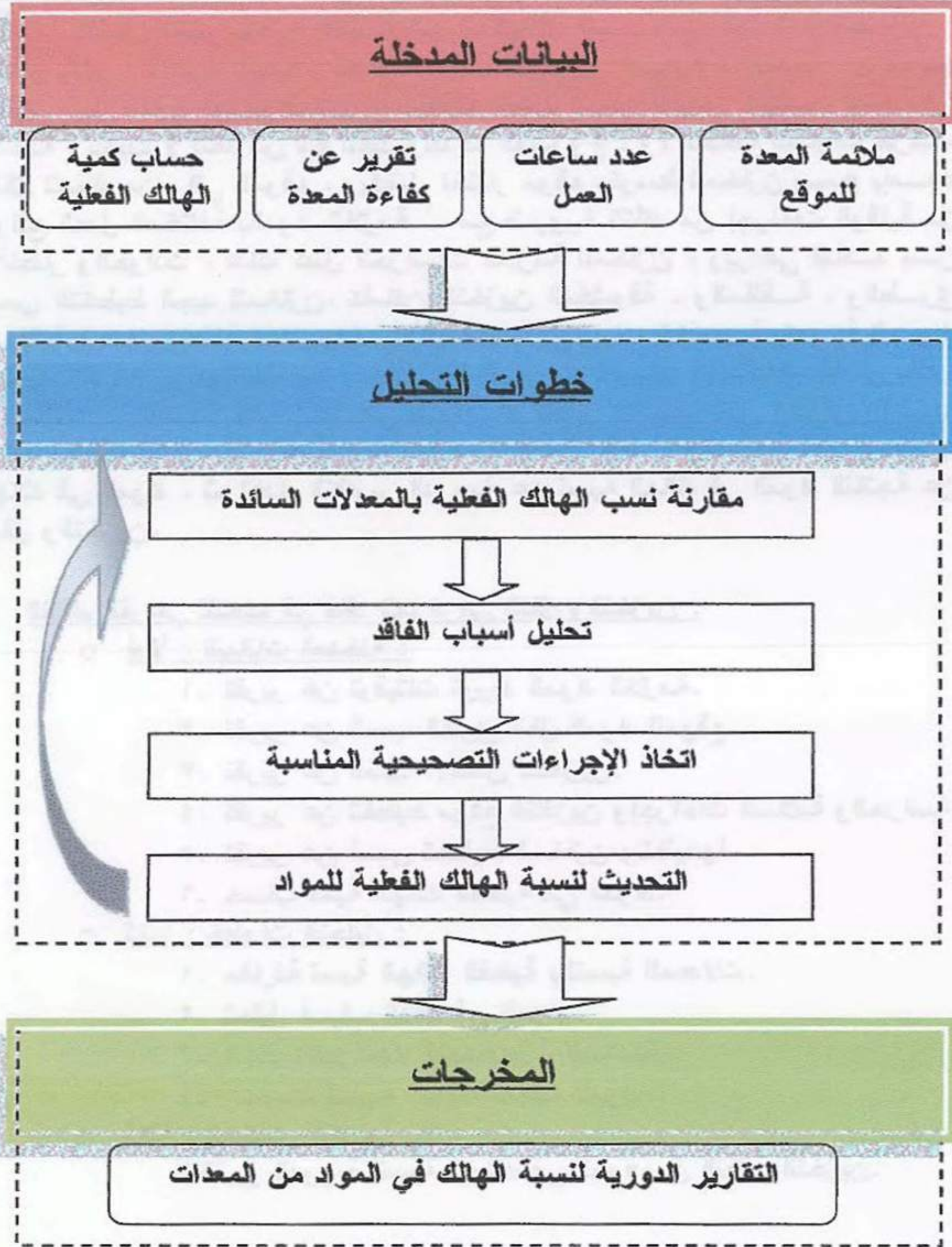
شكل ( ٤-٢ ) النظام الفرعي لترشيد استهلاك المواد في المعدات المستخدمة
