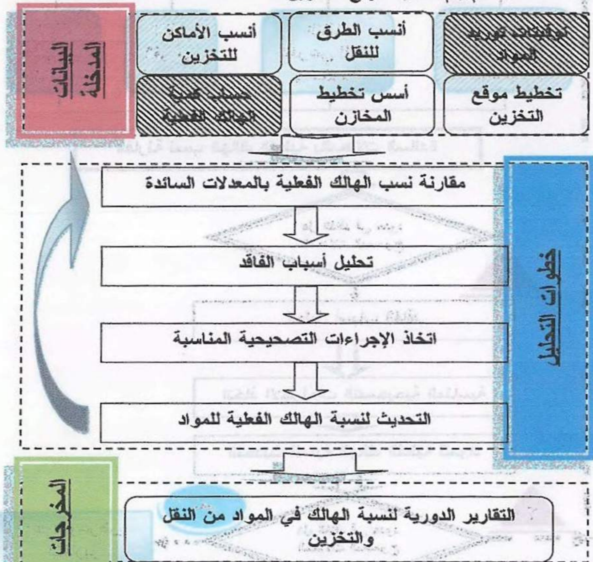
شكل ( ٤٩-٤ ) النظام الفرعي لترشيد استهلاك المواد في النقل والتخزين يلاحظ فيه عدم تظليل الخطوات الغير منفذة بالنظام
