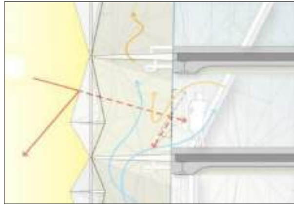
شكل (٣-٣١) حركة الهواء بالأبراج لتهوية الفراغات وتبريد الغلاف (وضعية فتح وحدات الغلاف الخارجي) ٣٢٣ .
