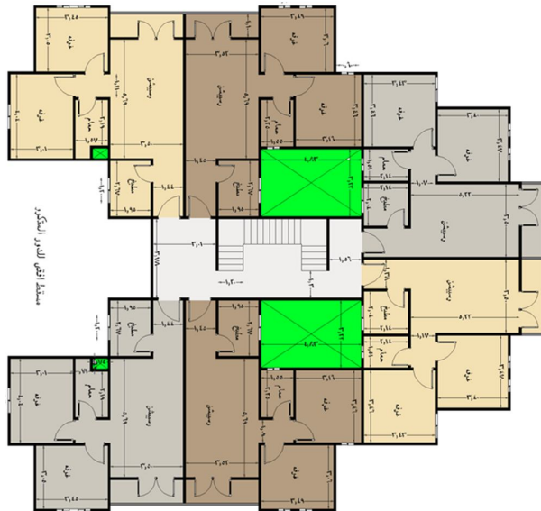
رسم توضيحي ٣٤: يوضح التعديل المقترح للدور الأرضي للعمارة السكنية للمشروع محل الدراسة. المصدر: إعداد الباحثة.
