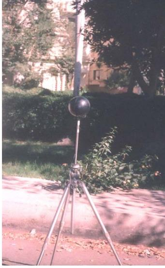
يعد هذا الجهاز احدى اجهزة قياس الراحة الحرارية ، حيث يستخدم Globe Thermometer لقياس درجة الحرارة ، لأنه يتفاعل مع البيئة المحيطة بنفس الطريقة التي يتعامل فيها الشخص مع البيئة .
