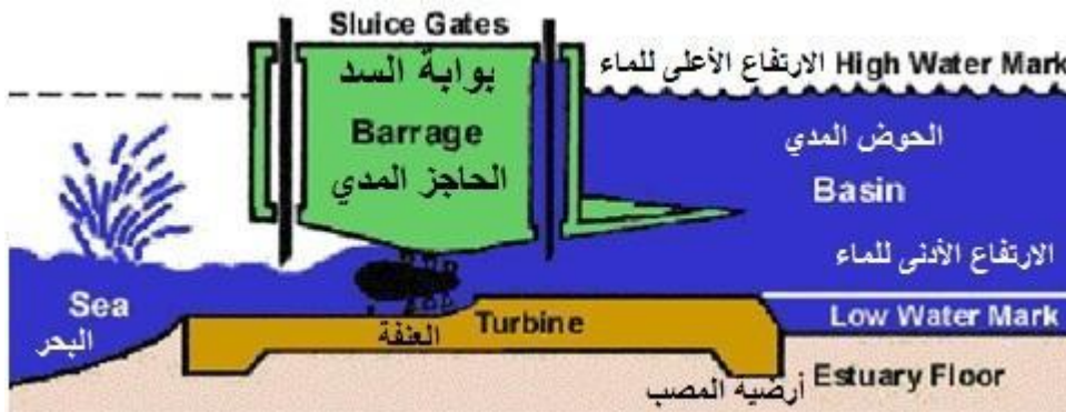
يوضح الشكل طاقة المد والجزر لإنتاج الطاقة الكهربائية
