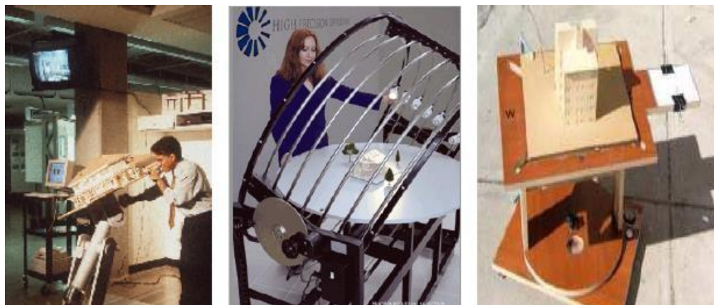
يوضح الشكل أنماطًا مختلفة من النمذجة الفيزيائية لهليودون
