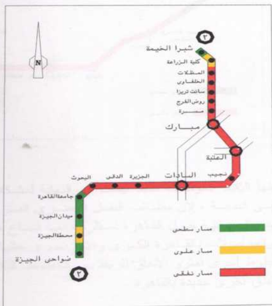
شكل (٣-٤) الخط الثانى بشبكة متر أنفاق القاهرة الخط الحضرى الأول (شبرا الخيمة - ضواحي الجزيرة)
