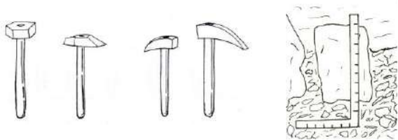
الأدوات التقليدية المستخدمة في تشكيل الأحجار .
