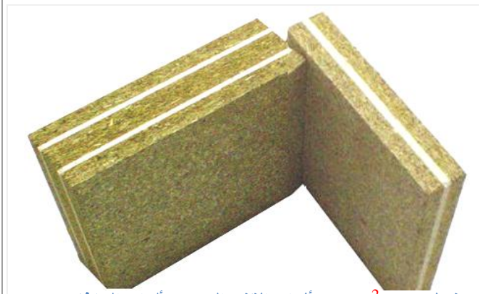
شكل (45) 2 توضح ألواح القش المدعم بألواح الماغنسيوم .
