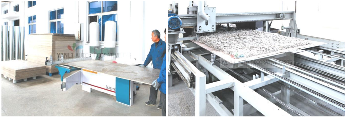
شكل (80) يوضح طريقة تصنيع ألواح ألياف القنب "Hemp fiber board".
