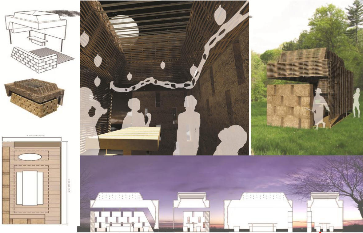
شكل (116) 2 يوضح منظور خارجي لقاطوع القش ، ومدى التأثيرات الخارجية وقدرة بلات القش على مواجهاتها .
