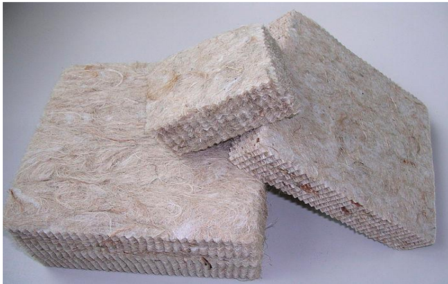
شكل (82) يوضح استخدام ألياف القنب المستخدمة في العزل على هيئة بلاطات .
