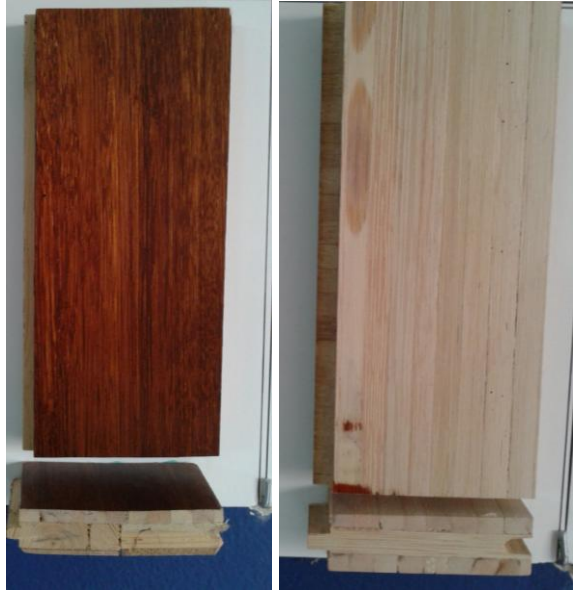
شكل (92) 3 توضح ألواح الكونتر بانوه " المكونة من طبقة واحدة و3 طبقات ومغطة بطبقة من الأبلكاش .
