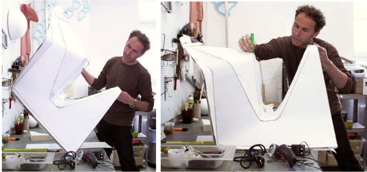
شكل (298) 3 يوضح شكل القوالب الخاصة بمقعد القنب .
