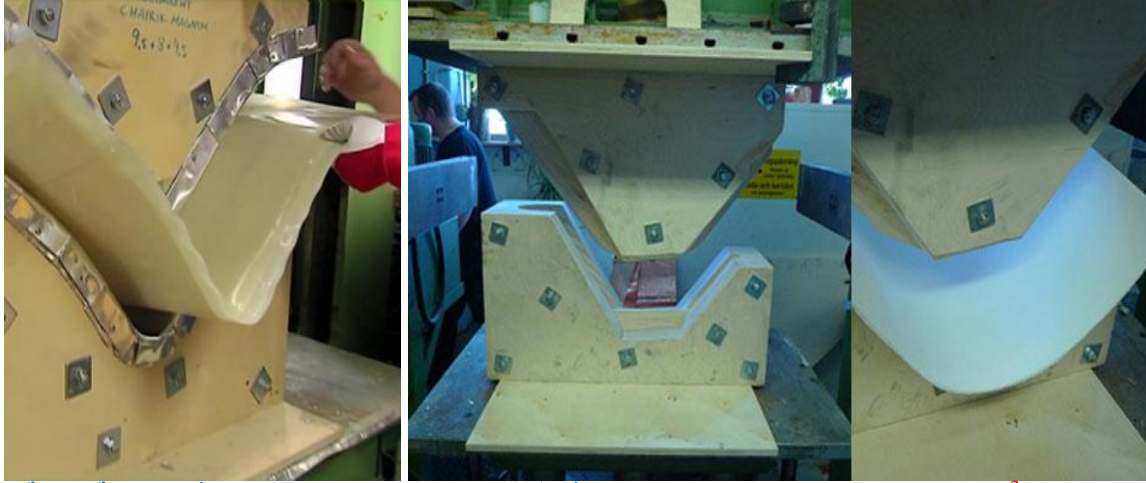
شكل (428) 3 تصنيع وحدة إضاءة " Rune w101 " في قوالب التصنيع بتكنولوجيا النانو ذات التقنية العالية .
