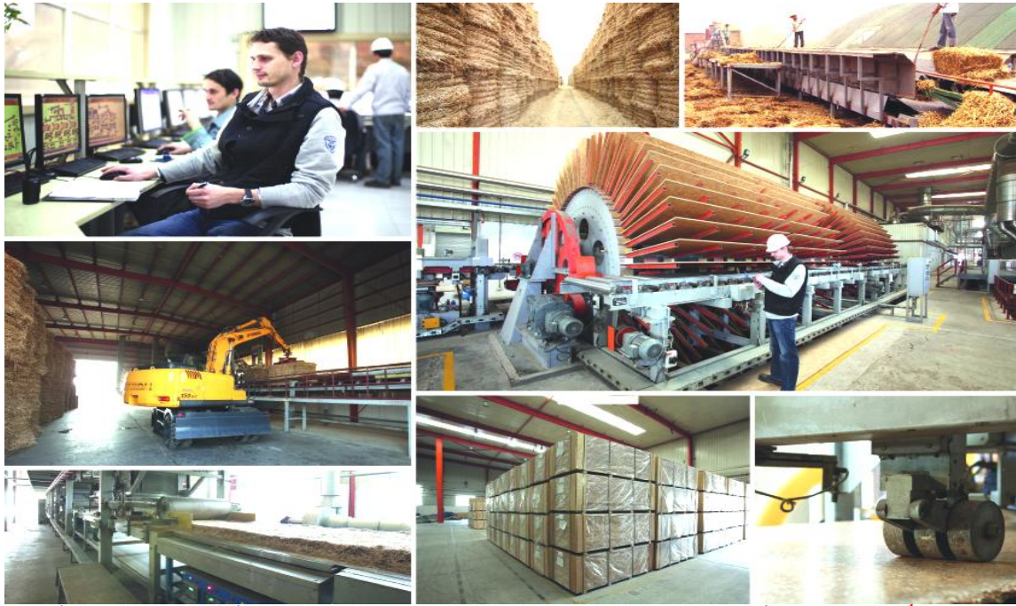
شكل (50) 1 مراحل تصنيع ألواح القش المضغوط ، حيث يتم تجميع القش اولا ثم وضعة في قوالب و ضغطة تحت درجات حرارة عالية .
