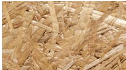
شكل (48) 2 يوضح تحول قش القمح إلى ألواح "OSSB".
