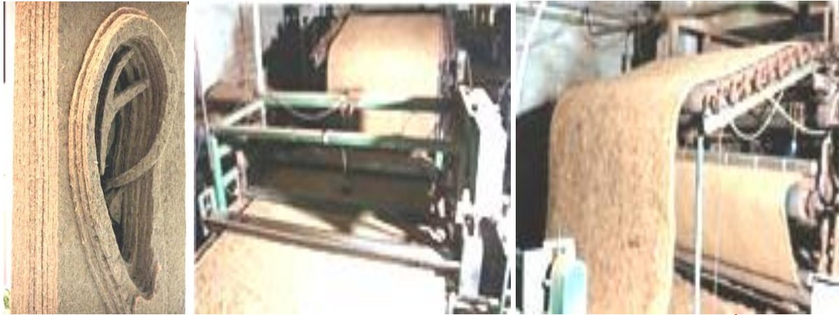
شكل (103) 1 يوضح عملية تصنيع ألواح الليف الهندي المضغوطة "CoirBoard"، وإمكانية تشكيل ألواح الليف الهندي المضغوط، لتستخدم في العمارة الداخلية كعازل أو كعمل فني .
