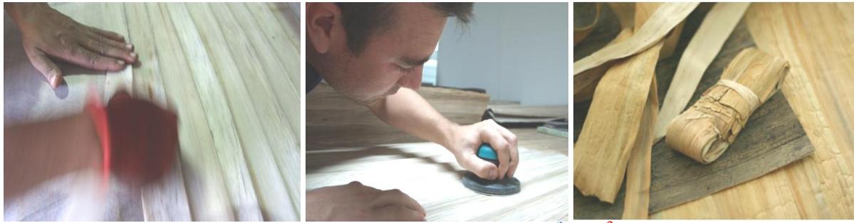
شكل (98) 3 طريقة تصنيع ورق الحائط "Nature" من الخوص يدوياً .
