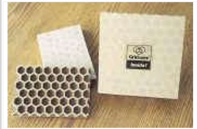
شكل (33) 2 بلاطات من الواح جريدكوري "Gridcore" ، لتوضح الطبقة الوسطى من اللوح والتي تتميز بشكل قرص شمع العسل .
