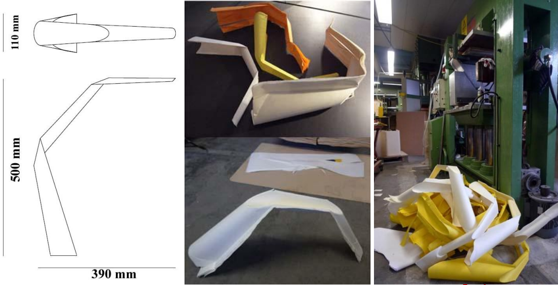
شكل (429) 6 ، 7 توضح صنفرة وحدة إضاءة " Rune w101 " بعد التصنيع وإزالة الزوائد لإعدادة جيدا ، لإظهار تصميمة الاوريغامي الصلب الذي يسهل طيها والتعامل معه 8 .
