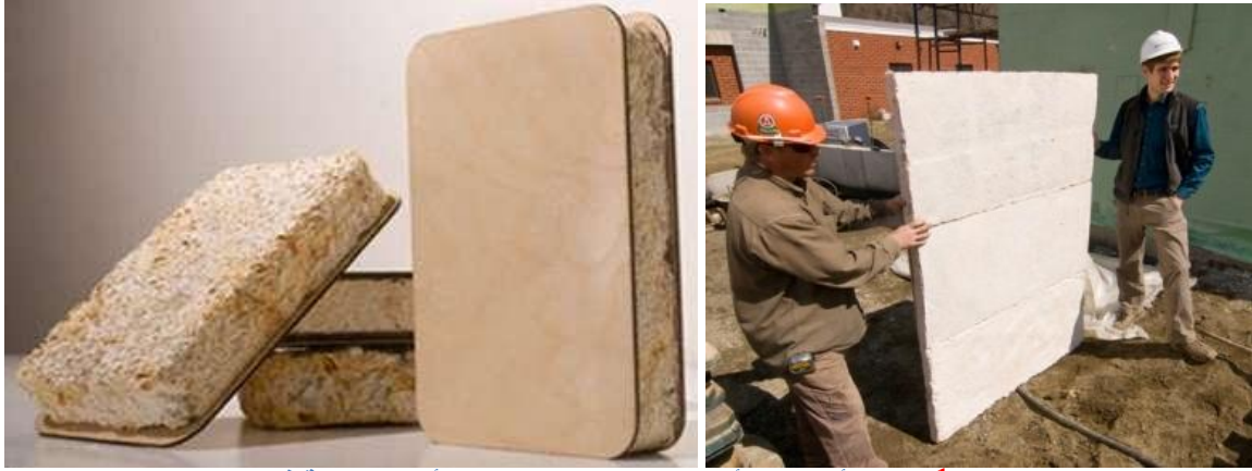
شكل (402) 1 يوضح استخدام ألواح "Greensulate" كألواح هيكلية في البناء .
