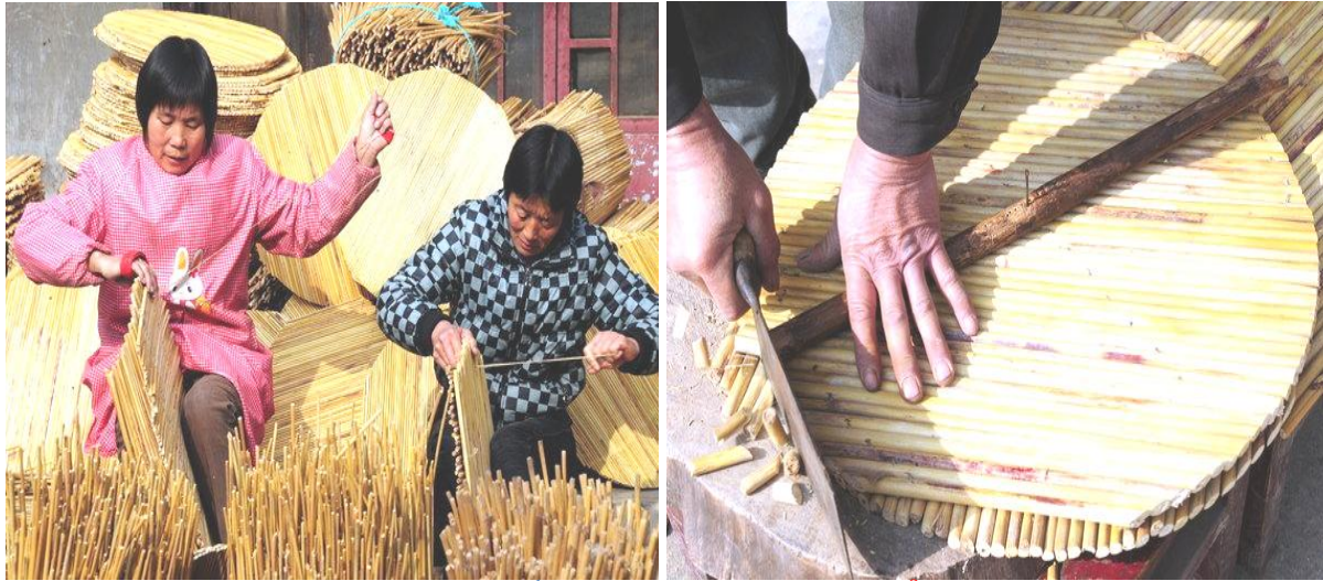
شكل (65) 8 يوضح صناعة الألواح المستديرة من سيقان الذرة الرفيعة.
