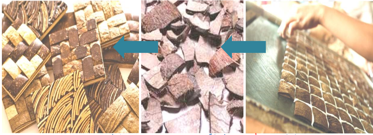
شكل (107) 1 يوضح طريقة "Coco Tiles" تصنيع بلاطات يدويا .
