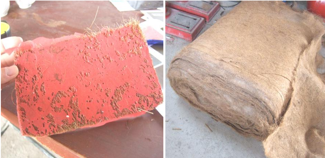
شكل (363) 1 يوضح خامة الليف الهندي ودمجها مع الراتنج.
