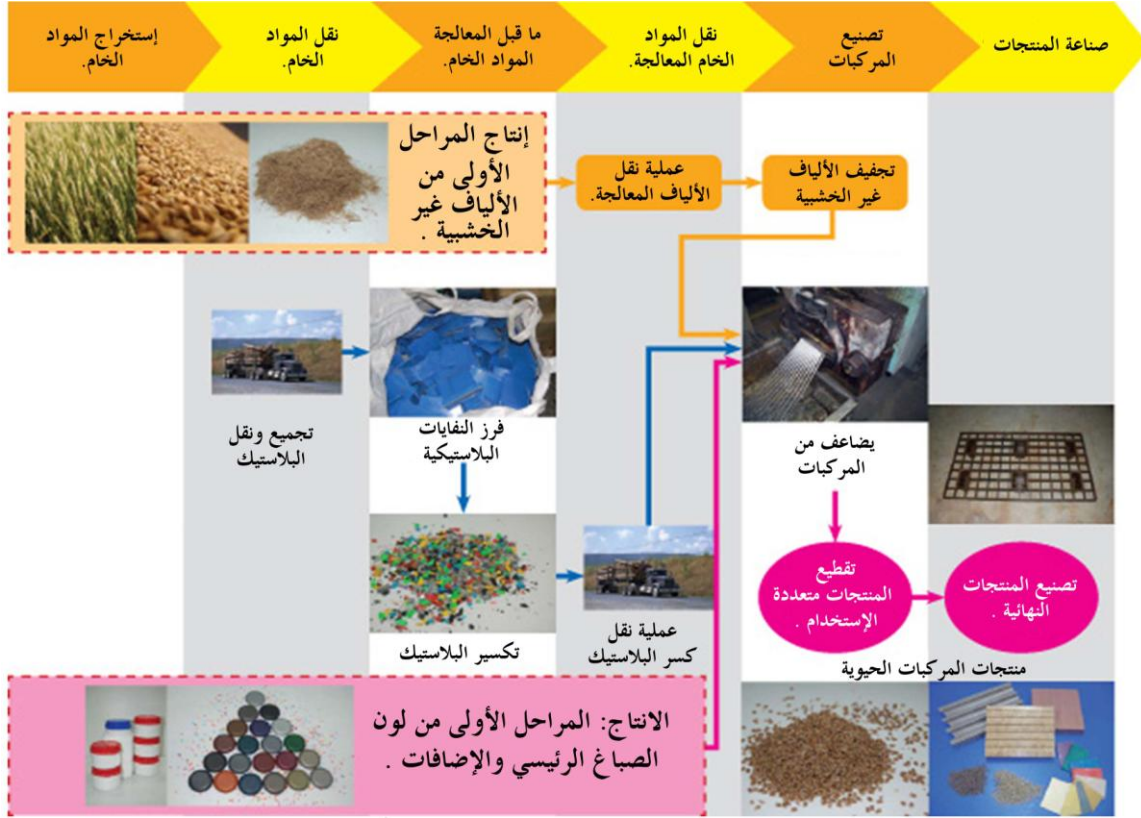
شكل (388) يوضح خط إنتاج البلاستيك العضوي ، حيث يمكن خلط البلاستيك المعاد تدويره مع بعض البواقي النباتية وتحويلها إلى ألواح "WPC" لتمر بمرحلة القص ثم التعديل والتعبئة 1 ، لتجمع كل مزايا الأخشاب والبلاستيك معا ، حيث يمكنها أن تحل محل الخشب وتتميز بأنها مقاومة للماء صديقة للبيئة .
