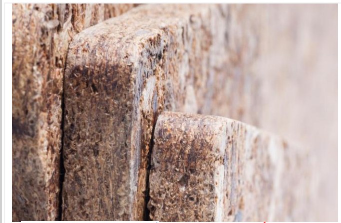
شكل (72) 1 يوضح شكل وسمك ألواح قشر الفول السوداني (Peanut Shell Board).
