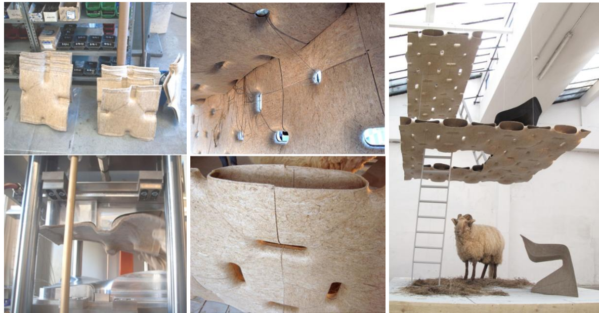
شكل (300) 5 يوضح " بيت القنب " ، و بلاطات القنب أثناء التصنيع بتكنولوجيا "CNC".
