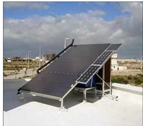
Fig(155): "Mediras" solar desalination model, http://www.mediras.eu/
