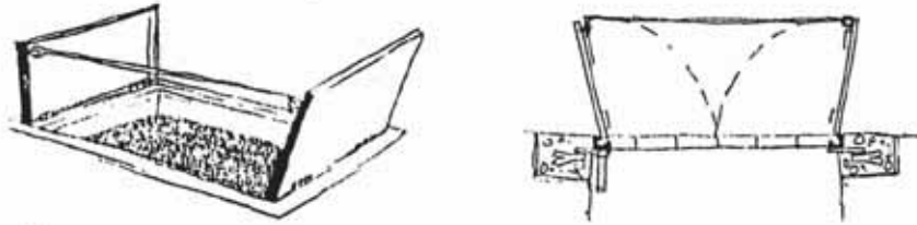
(شكل ٢-٥٥) يراعى عند استخدام هذا النوع من الأغطية أن يكون فتحة الغطاء إلى أعلى وأن تكون السلسلة التي تربط ضلعتي الغطاء بلون ظاهر مع تثبيت العواكس الضوئية أما الفتحة (١)
