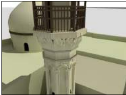
(Fig. 99) La terrasse du mu'ḍin portée par deux rangs de muqarnasas
