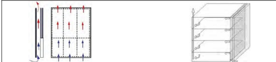
شكل رقم (٦٩-٢) منظور يوضح فكرة التهوية بالواجهة الصندوقية ، رسم تخطيطي يوضح طريقة عمل الواجهة الصندوقية (٢) .
