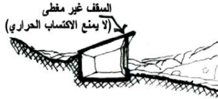
شكل (٥-٢٢): تغطية سقف المبنى بالتربة، فضلاً عن حماية الحوائط، يحسن الأداء الحراري للبناء.
