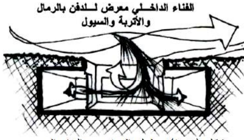
شكل (١-٥): سلوك الرياح مع البناء المحمي بالترربة ذو الفناء الداخلي.
