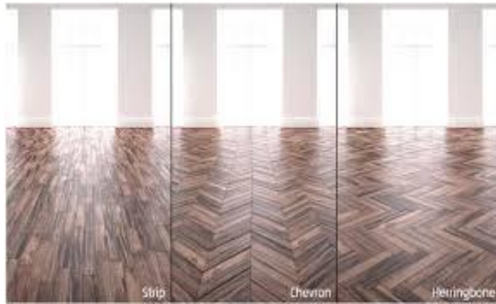
شكل رقم ( ٤٧ ) يوضح بعض طرق تجميعات الأرضيات الخشبية
