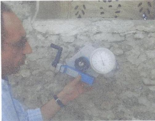
صورة توضح جهاز يستخدم قوة تماسك بين الحجر والطبقة التحضيرية
