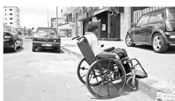
شكل (4): يوضح صعوبة إنتقال أحد المعاقين بالكرسي المتحرك من طريق الأليات الي مسار المشاة نتيجة إرتفاع فرق المنسوب وعدم وجود منحدر للمعاقين، (المصدر: حماد، 2011) [11] .
