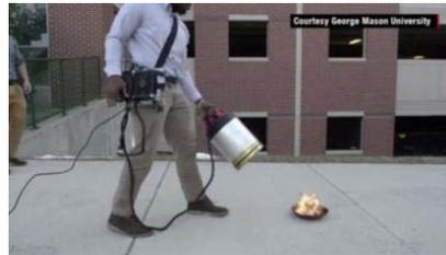
صورة 9: جهاز "ضاعف الهواء" يتم توجيهه نحو النار، و هو جهاز قائم على فكرة الباس الموسيقي ذو الصوت الثخين.
