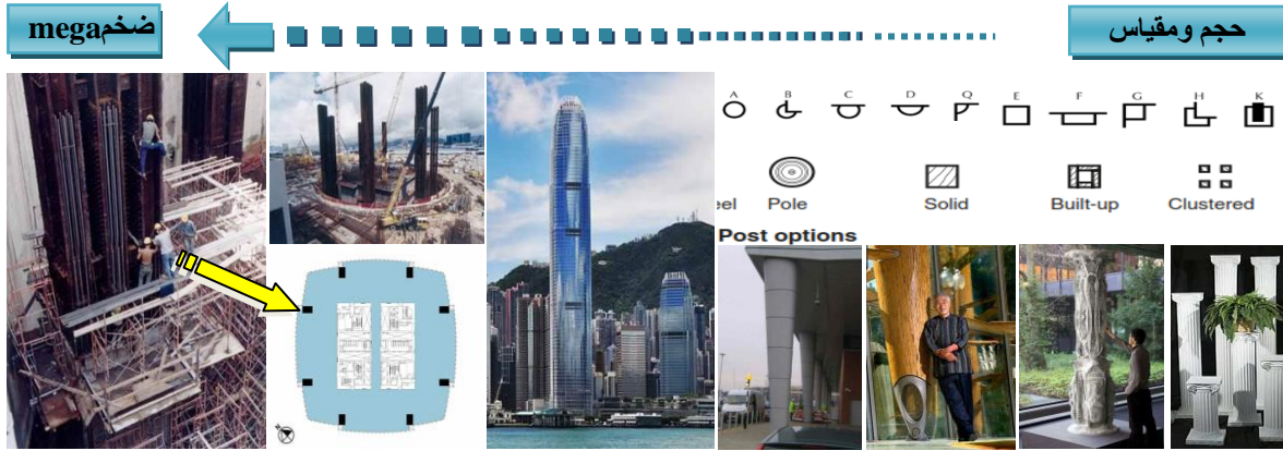
شکل ٧. يوضح أمثلة لإحتمالات قطاعات الأعمدة ولتدرج حجم العمود تبعاً لوظيفته ، المصدر : [١٧]، [١٤]، [١٧]
