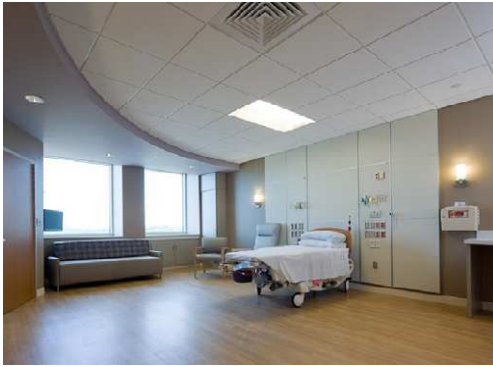
شكل (٥-١٨) يوضح استخدام بلاطات السقف الماصة للصوت. ٢
