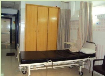
شكل (٧-١٦) غرفة المرضي الزوجية، توفير دواليب لتخزين ممتلكات المرضي، ولا يوجد بالغرفة دواليب لتخزين المعدات، وصناعة الدواليب من مادة الخشب ويعد الخشب مصدر جيد مغذي للبكتريا.
