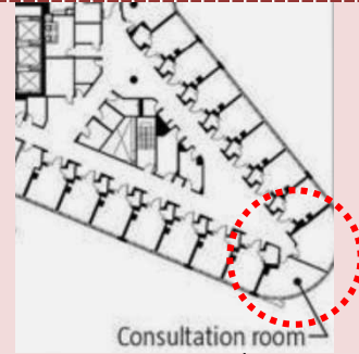
شكل (١٨-٦) مسقط أفقي لغرف الإقامة و غرف الكشف مع توافر مصدر للإضاءة الطبيعية لغرف الفريق الطبي.
