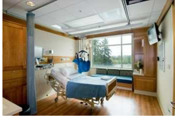
شكل (٥-١٧) يوضح استخدام بلاطات السقف الماصة للصوت بمستشفى ميثوديست برونسون في كالامازو، ميشيغان. ٣
