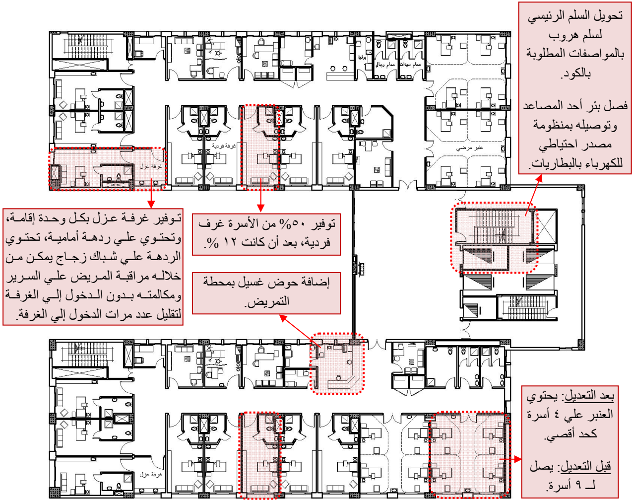
شكل (٧-٩٣) مسقط أفقي لدور الإقامة بعد التعديل، ويحتوي علي وحدتين إقامة بكل وحدة ١٦ سرير ( ٨ غرف فردية منهم غرفة عزل، و٢ عنبر بكل عنبر ٤ أسرة) (الباحثة).
