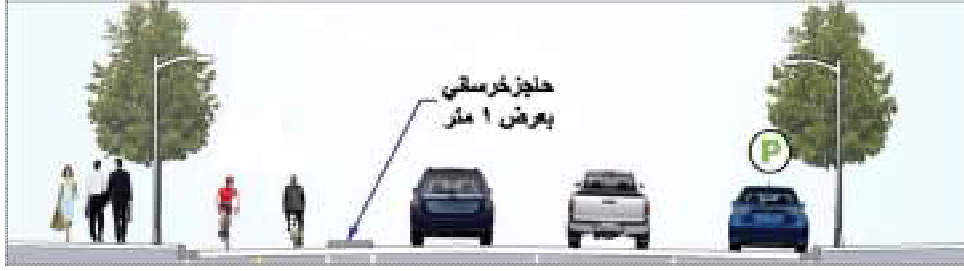
شكل (١٨-٤) عمل حاجز خرساني للفصل بين مسار الدراجات ومسار السيارات المصدر: (Nov. 2017) https://thirdwavecyclingblog.files.wordpress.com
